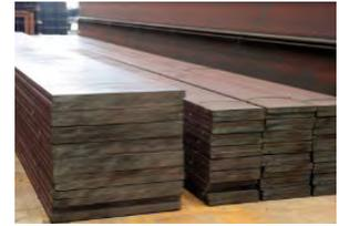
熱軋製程所生產的平板類鋼品，鋼品強度、韌性均佳，銲接性良好，容易加工成各種形狀複雜的零組件。
