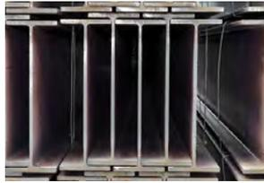
型鋼為一定截面形狀和尺寸的條型鋼材，鋼胚加熱經軋延製成，為建築（鋼構）、構造物（橋樑、船舶、車輛用等）之主要鋼鐵材料。
