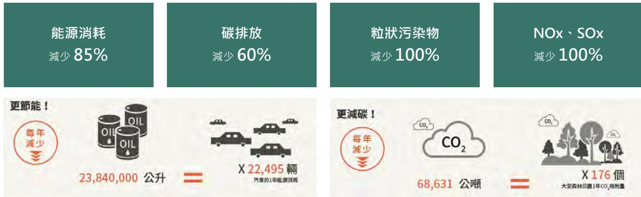
沒有加熱爐的直接軋製程約可較單軋廠之製程節省 29.8 (公升 - 重油 / 公噸 - 鋼筋) 之能源耗用，每年可減少 2,384 萬公升重油耗用，約當於 22,495 輛汽車之年能源耗用 (以每輛車年行駛 15,000 公里，平均油耗每公升 12 公里計算)。
